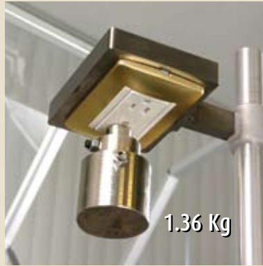
Prueba de sujeción para Toma de Corriente (NMX-J-508-2003, INCISO 6.3.3): La toma de corriente soporta un peso de hasta 1.3 Kg. sin que la clavija se desconecte.
